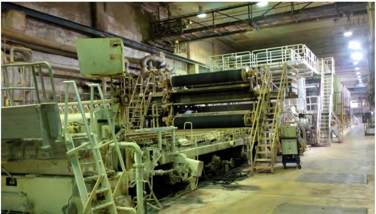
**Abb. 27:** Moderne Papiermaschine (Siebpartie, rechts Nasspartie)
