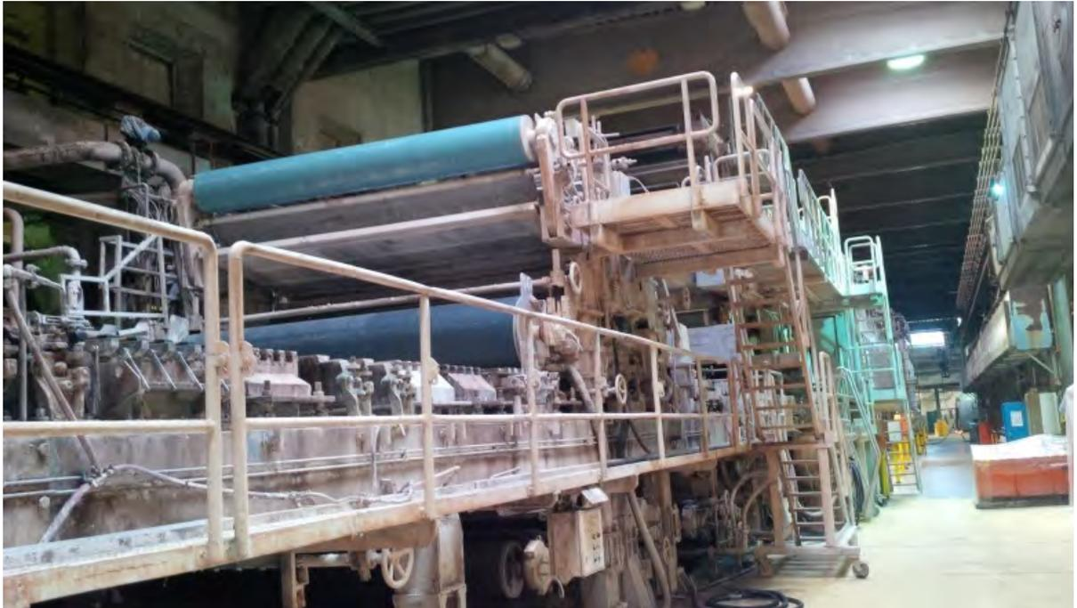
**Abb. 28:** Moderne Papiermaschine (Nasspartie und Trockenpartie)
